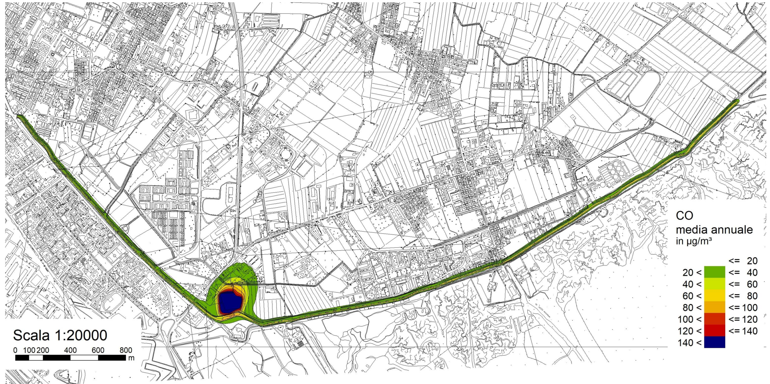
Figura 31: Concentrazione media annuale di CO dovuta allo svolgimento delle attività di cantiere.
