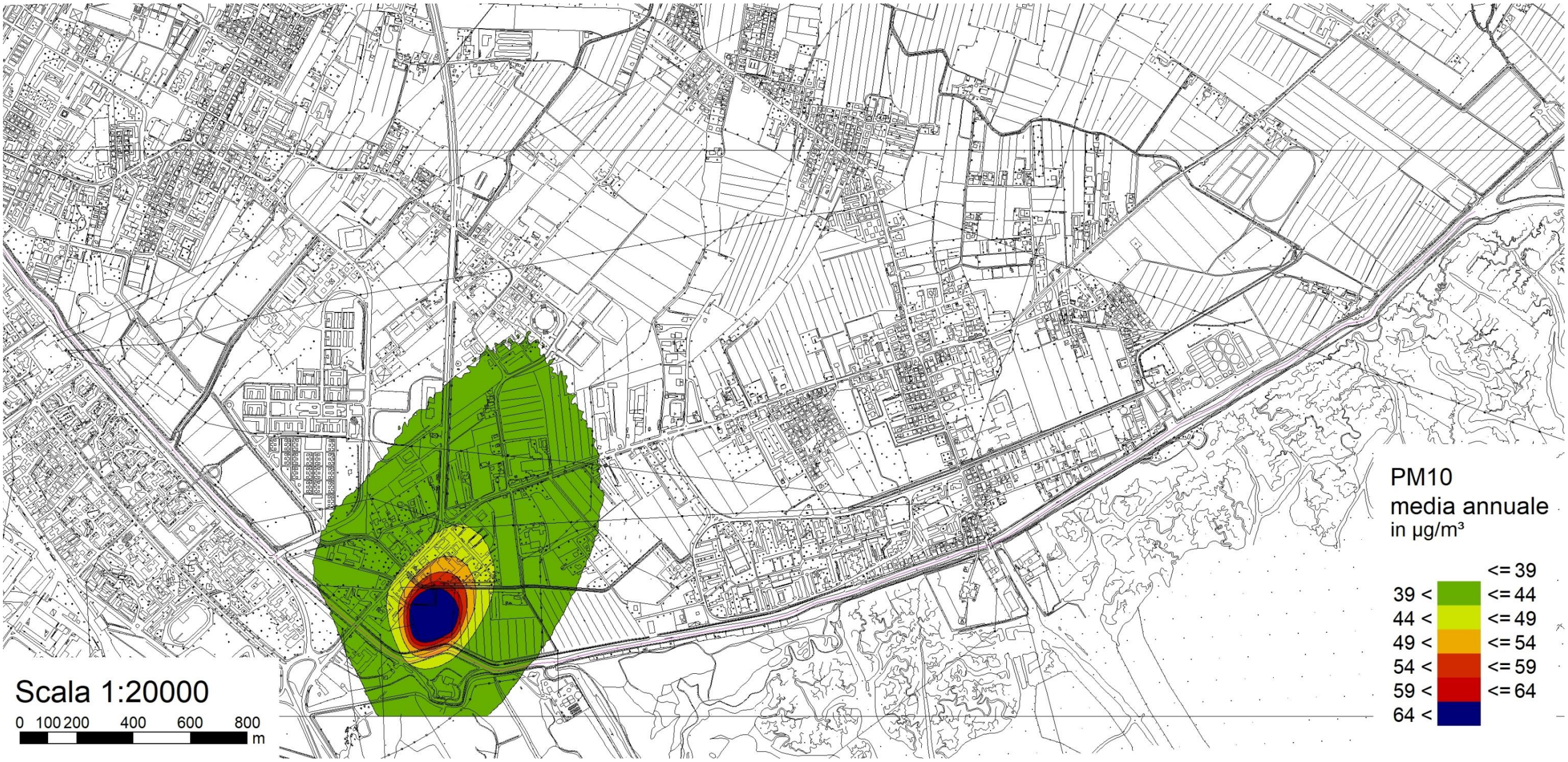
Figura 27: Concentrazione media annuale di PM10 dovuta allo svolgimento delle attività di cantiere considerando un valore di fondo di 38,5 \mu\text{g}/\text{m}^3 .
